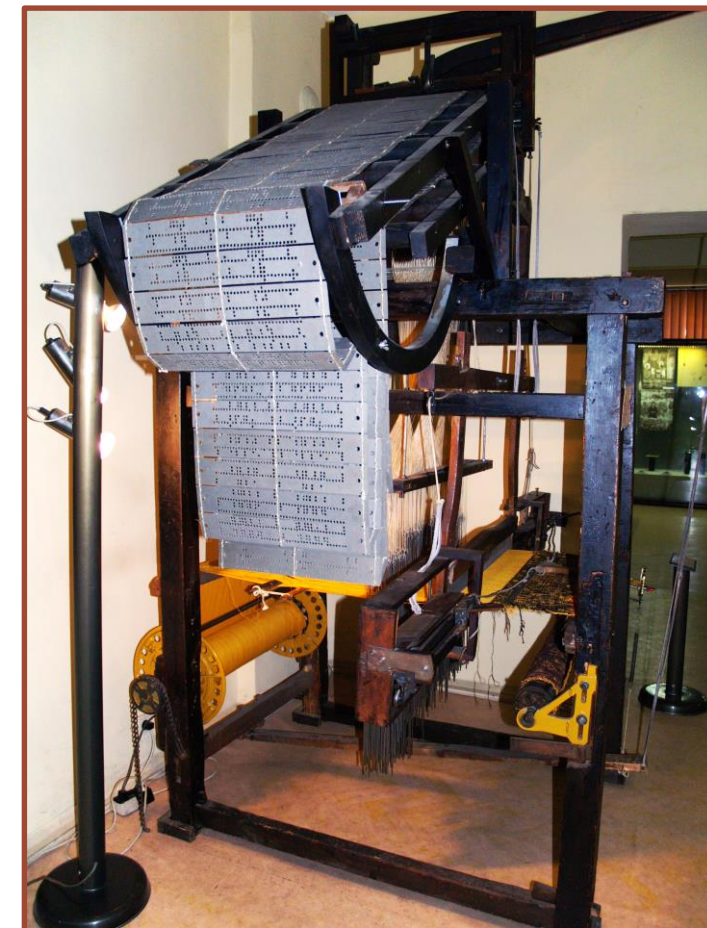
Război mecanizat austriac de tip Jacquard
