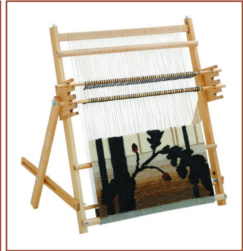
Război vertical „de tapiserie” tip SCHACHT 25
