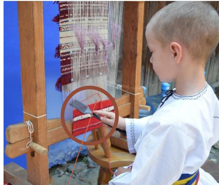
Los hilos de la trama se fijan con la horquilla
